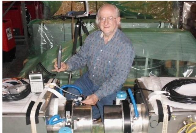
Dipl.-Ing. Gary Zörner führt Luftpartikelsammlungen mit einem von ihm selbst speziell hierfür entwickelten Verfahren an einer medizinischen Produktionsanlage/Reinraumschleuse bei Atlanta (USA) 2018 durch. Das Gutachten über die festgestellte Schimmelpilzkontamination entschied über einen Schaden in Millionen US-Dollar.
