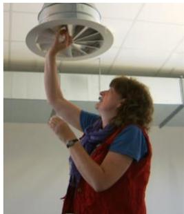
Dipl.-Ing. Renate Seyfert bei der Probenahme an einem Zuluftauslass einer Raumlufttechnischen Anlage (RLT-Anlage) Im Fokus stehen bei den Projekten Schimmel, Bakterien, Schadstoffe und Fasern.
